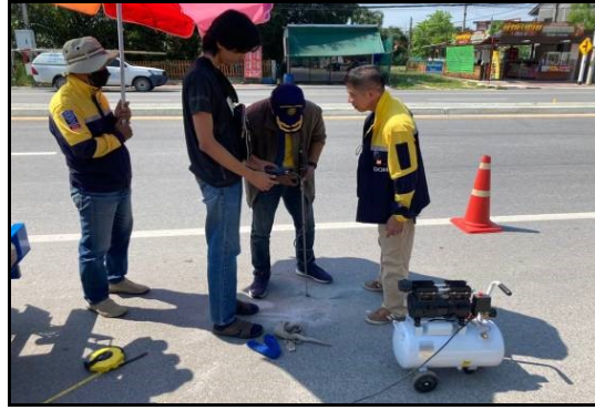
ภาพที่ 19 การเจาะสำรวจความหนาของโครงสร้างชั้นทางด้วยเครื่องมือ Borescope
