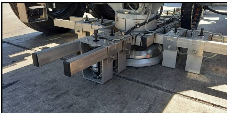
ภาพที่ 16 ตำแหน่ง Geophone ตัวที่ 2 และตัวที่ 3 คร่อมตรงบริเวณรอยต่อ
