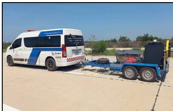
ภาพที่ 1 เครื่องตรวจสอบความแข็งแรงโครงสร้างชั้นทางแบบตึมน้ำหนักกระแทก Fast Falling Weight Deflectometer รุ่น Dynatest 8012
